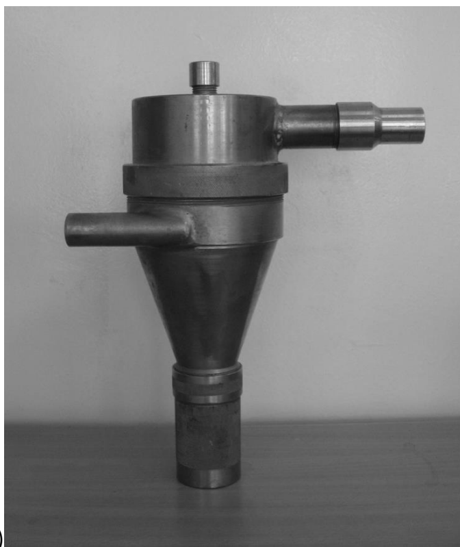
Рисунок 9 – Фильтр молочный двухступенчатый а) схема; б) общий вид.
